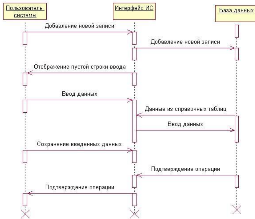
Рисунок 17 – Диаграмма последовательности при добавлении новой записи
