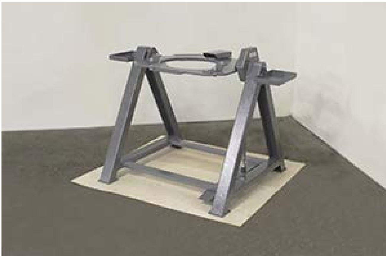
Рисунок 4 – Стенд для разборки и сборки редукторов задних мостов автомобилей Б252АМ
