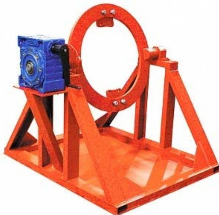
Рисунок 5 – Стенд-кантователь для разборки и сборки редуктора главной передачи (заднего моста) карьерных самосвалов БелАЗ
