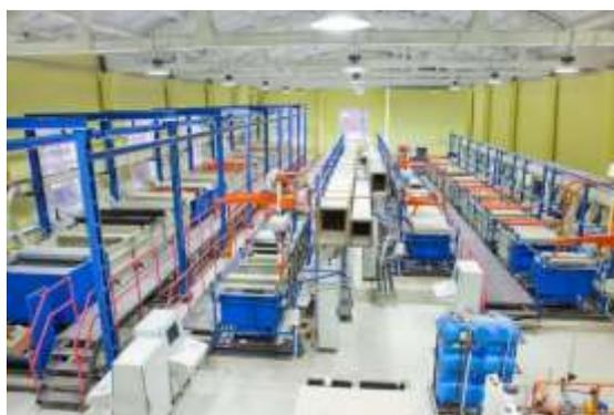
Рисунок 2 – Автооператорная автоматическая линия
