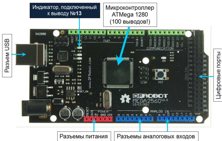
Рис. 8. Контроллер Arduino DFROBOT MEGA2560
