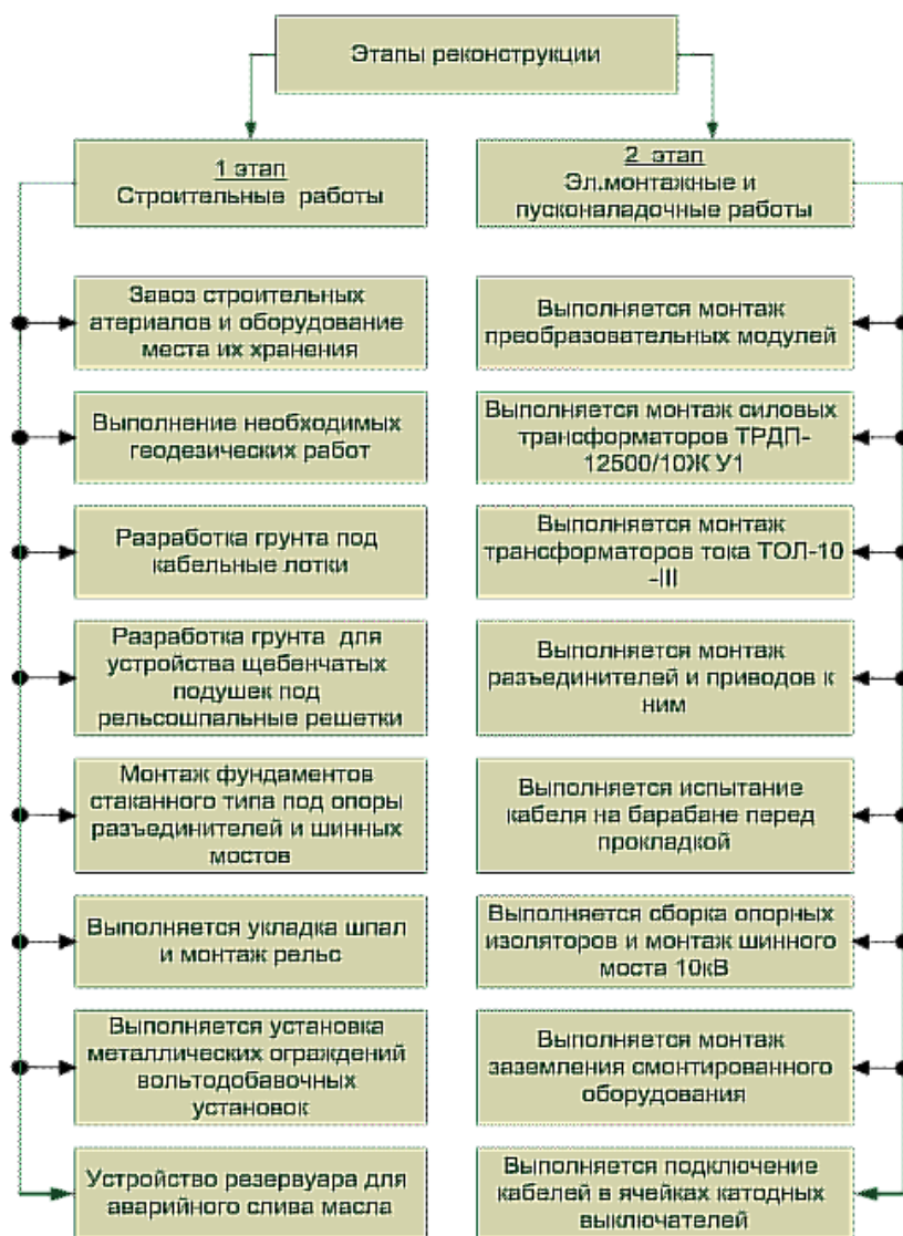
Рисунок 3 – Этапы реконструкции понизительных трансформаторных подстанций (на примере тяговой подстанции 12500/10 кВ переменного тока)
