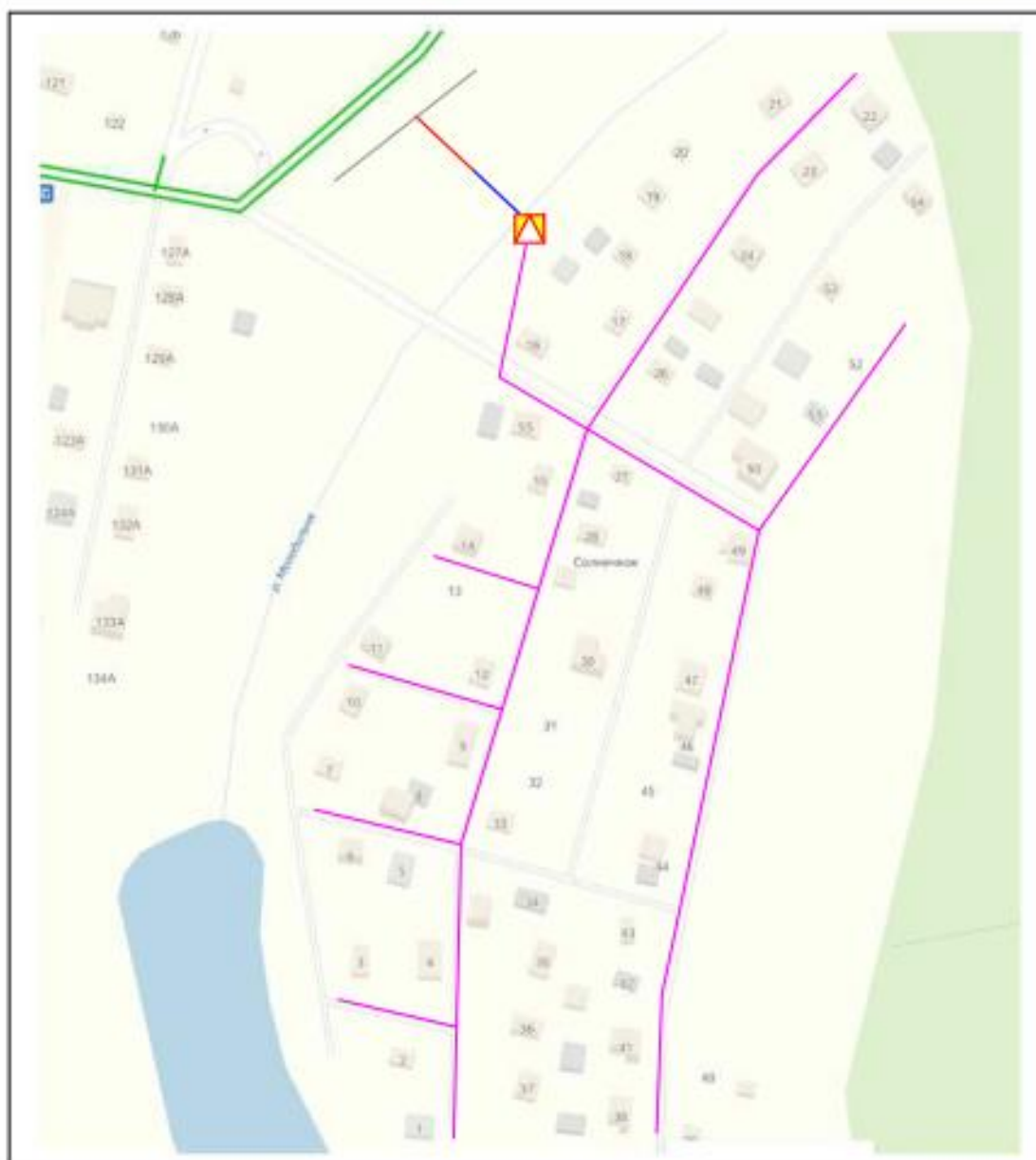
Рисунок 3 – Ситуационный план сетей 10 кВ и 0,38/0,22 кВ СПК «Солнечное» поселения «Вороновское» (с учётом новых коттеджей)
