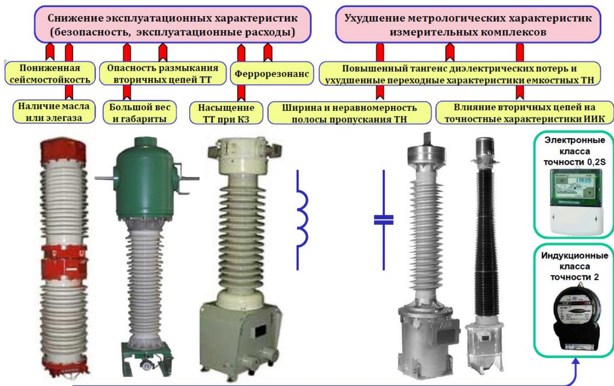
Рисунок 8 – Ключевые недостатки традиционных измерительных трансформаторов
