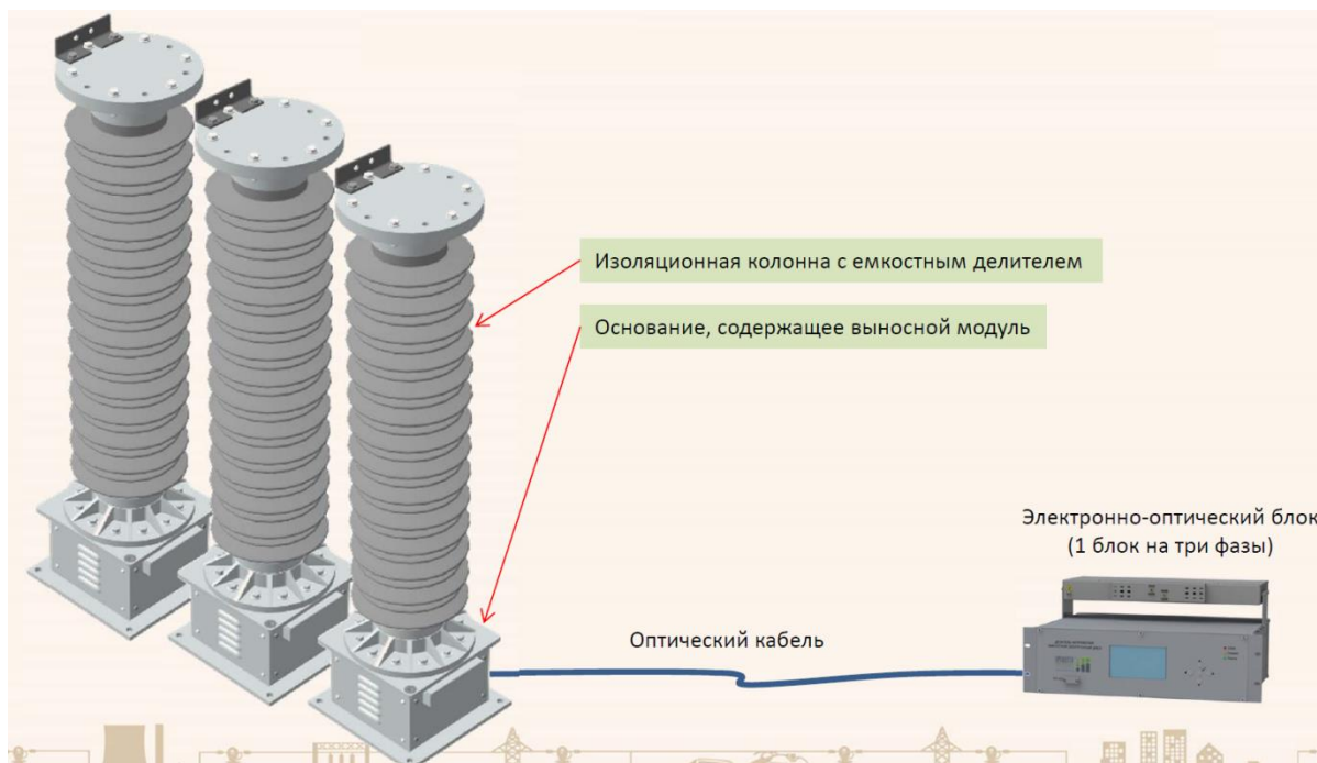
Рисунок 12 – Конструкция оптического ТН
