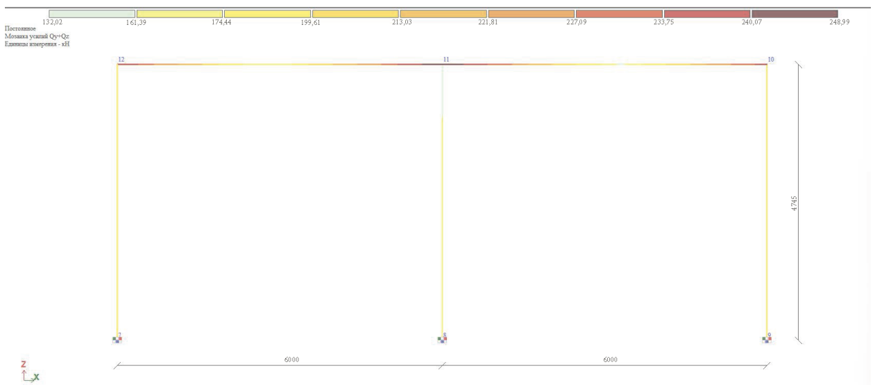
Рисунок 11 - Определение поперечной силы Q
