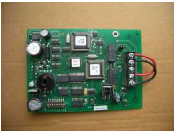
Рисунок 3 – Интерфейс на 250 адресных устройств IDNet «4100-3101»
