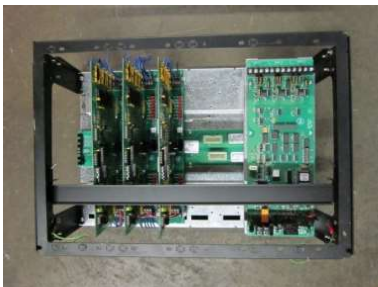
Рисунок 6 – Шасси для плат расширения системы «4100-2300»
