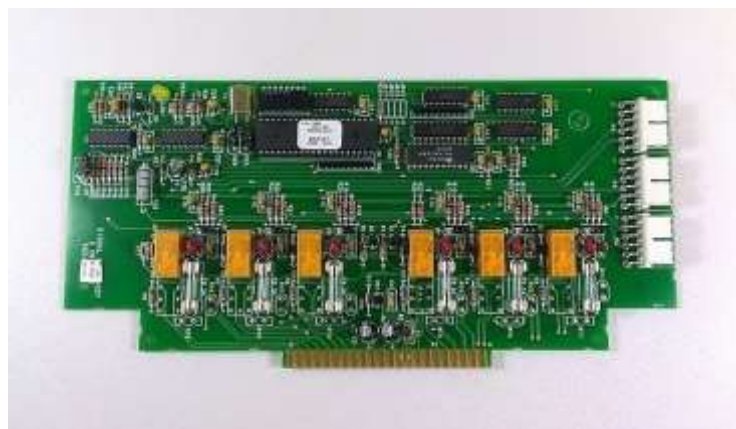
Рисунок 5 – Модуль проводного подключения к сети 4120 «4100-6056»
