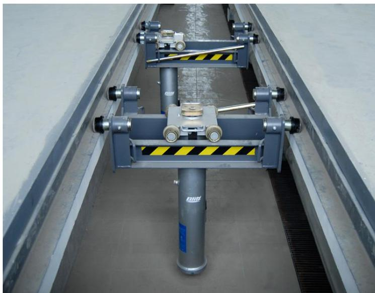
Рисунок 1 – Оборудование распределяющее ПКН-6
