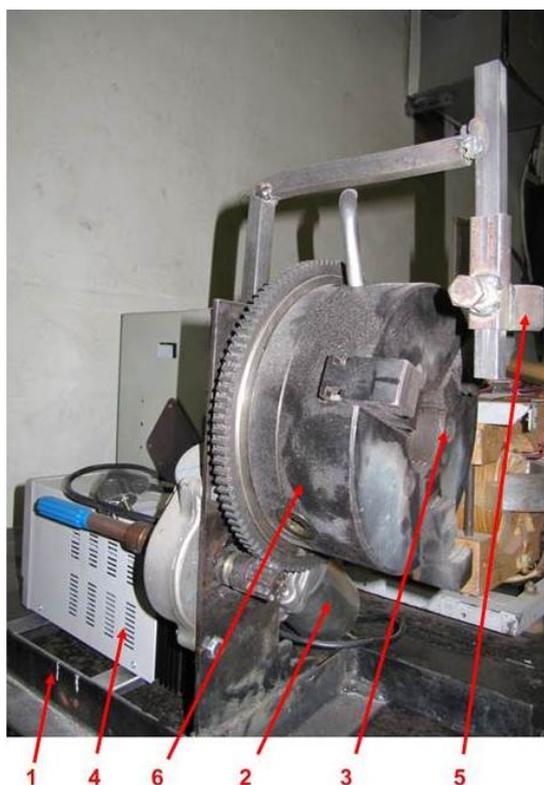
Рис. 4. Установка для полуавтоматической сварки в среде защитных газов
