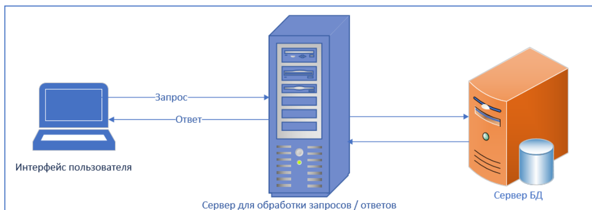
Рисунок 23 – Схема трехуровневой архитектуры системы
