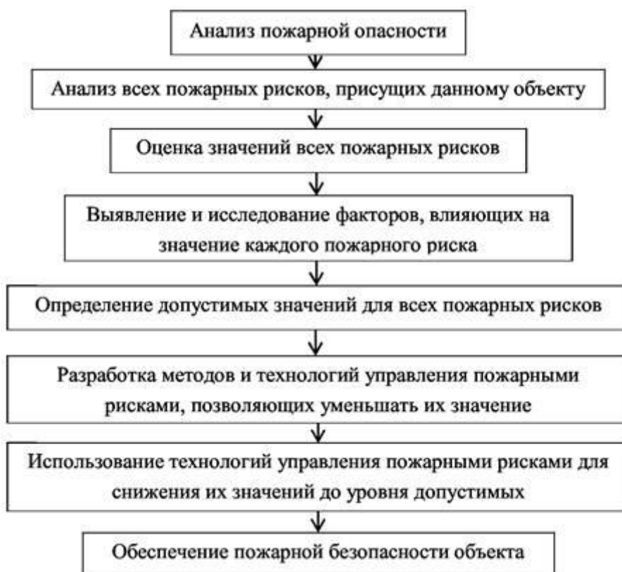
Рисунок 2.2- Алгоритм управления пожарной безопасностью объекта защиты
