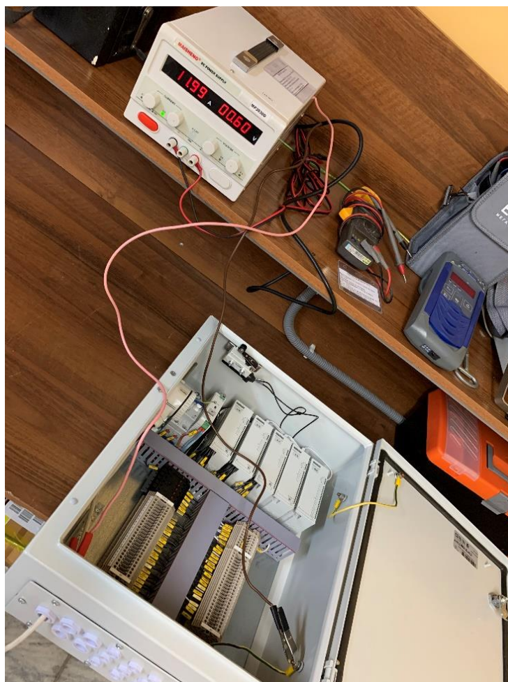
Рисунок 30 – Определение эффективности непрерывности электрической цепи заземления НКУ и защитной цепью
