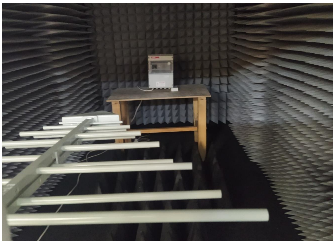
Рисунок 33 – Общий вид расположения тестируемой НКУ по отношению к приемной антенне в БЭК
