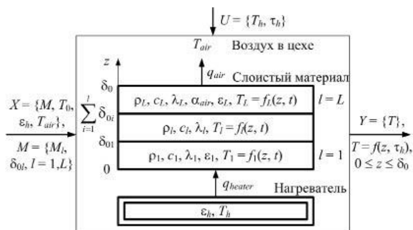
Рисунок 4 – Процесс роста температуры слоистого материала
