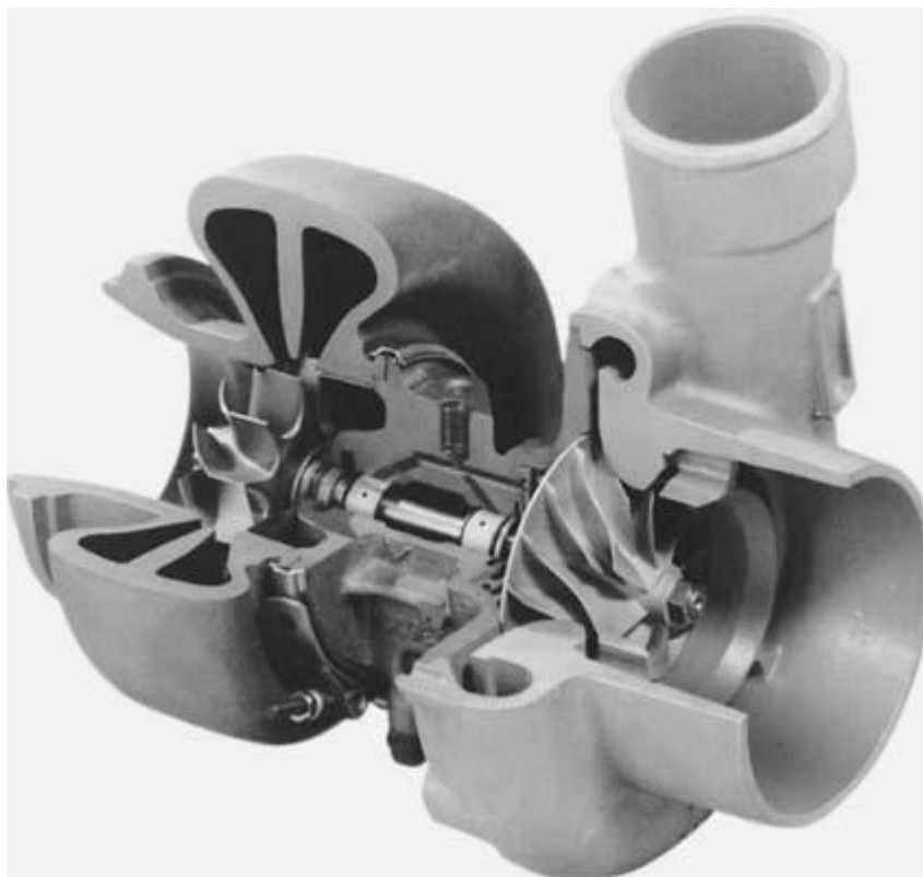
Рисунок 7 – Турбокомпрессор в разрезе [7]
