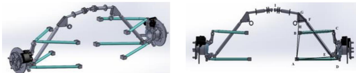
Рисунок 8 – Передняя подвеска: а – изометрический вид; б – вид спереди с маркировкой
