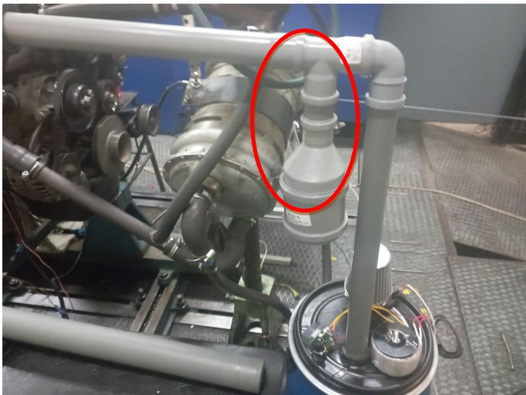
Рисунок 20 – Дополнительный ресивер (выделено) для сбора образующегося конденсата во впускной системе.
