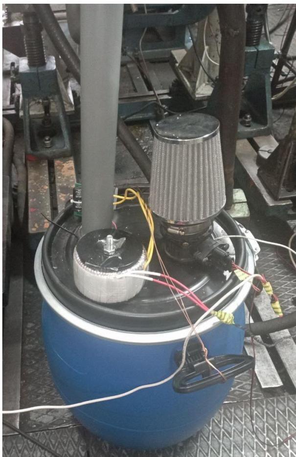
Рисунок 18 – Общий вид системы подачи ультразвукового пара
