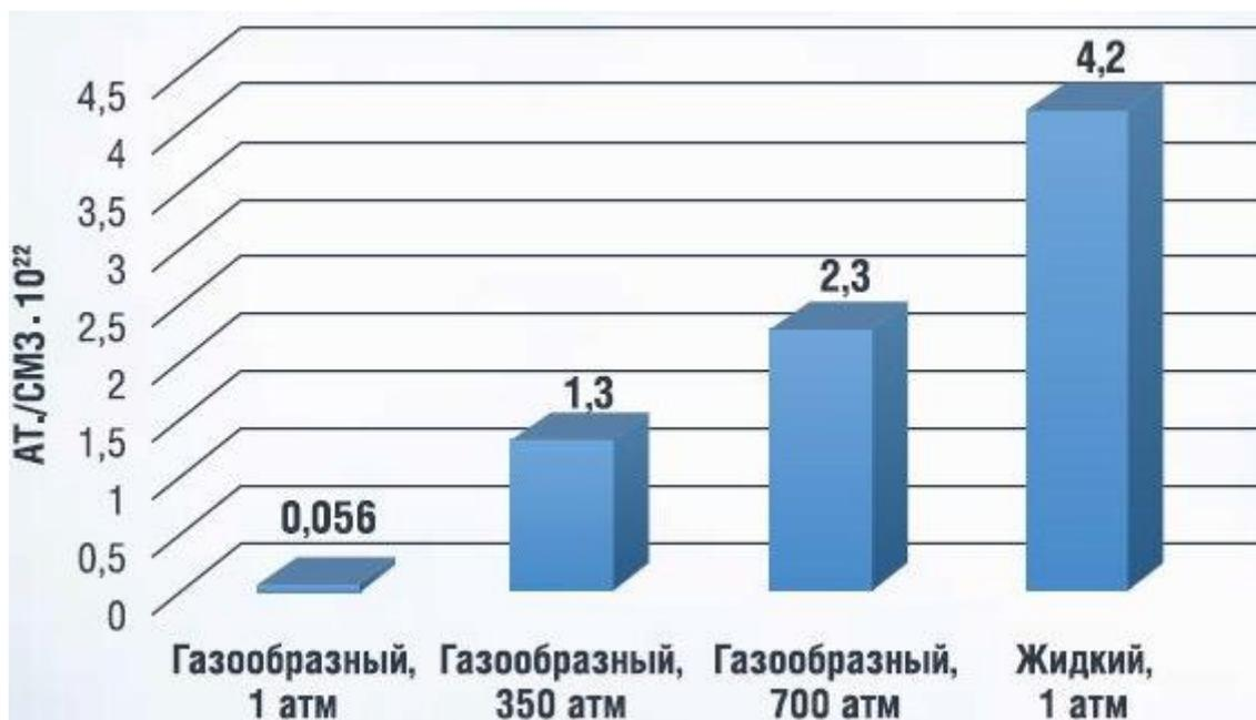
Рисунок 3 – Зависимость концентрации атомов водорода от давления
