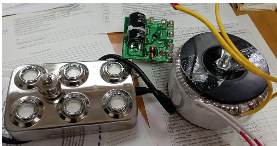
Рисунок 16 - Ультразвуковой модуль М6-4-48 + ТОР 300Вт.
