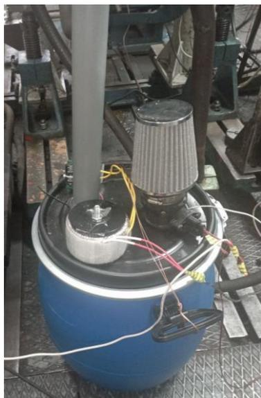
Рисунок 17 – Общий вид системы подачи ультразвукового пара
