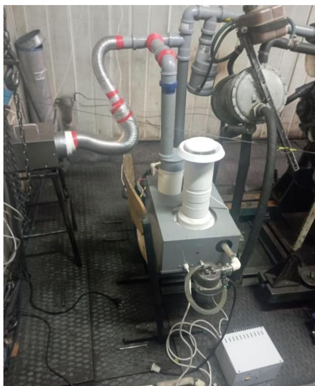
Рисунок 13 – Система подачи ультразвукового пара и системы ионизации воздуха на впуске
