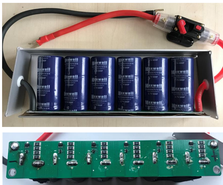
Рисунок 26 - Сборка ионистра (суперконденсатора) с балансирующей платой
