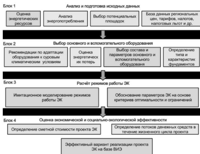
Рисунок 9 - Методология оценки оптимальных параметров автономного энергокомплекса на основе ВИЭ
