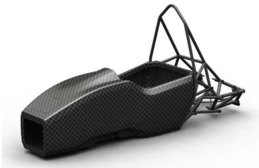
Рисунок 13 – Монокок болида класса FS
