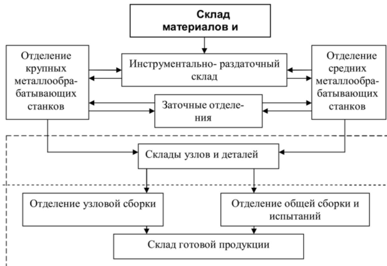
Рисунок 2 – Технологическая схема с указанием основных производственных и технологических узлов и подразделений проектируемого механосборочного завода универсального типа
