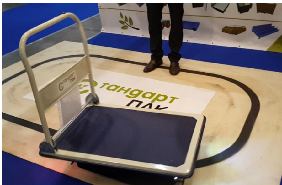
Рисунок 6 – Робот-тележка для (производства украинской компании СТАНДАРТ-ПАК), предназначена для транспортирования мелкого и габаритного груза на складе логистического комплекса Новой почты [1].
