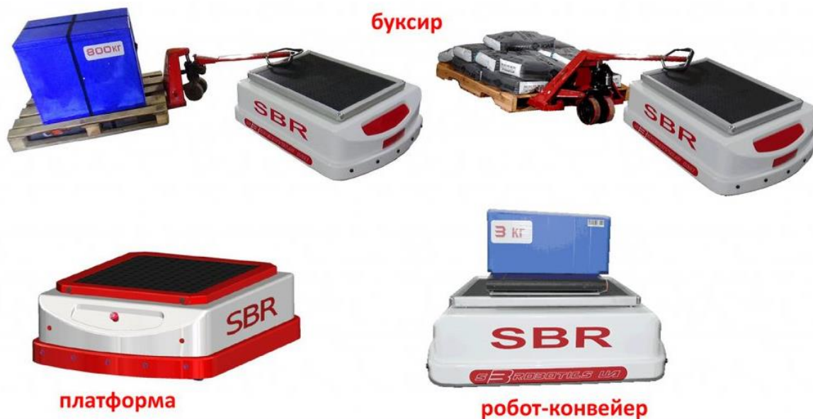
Рисунок 4 – Примеры автоматически управляемых транспортных средств, применяемых, в частности, в АТСС (на платформе SBR-300SM).
