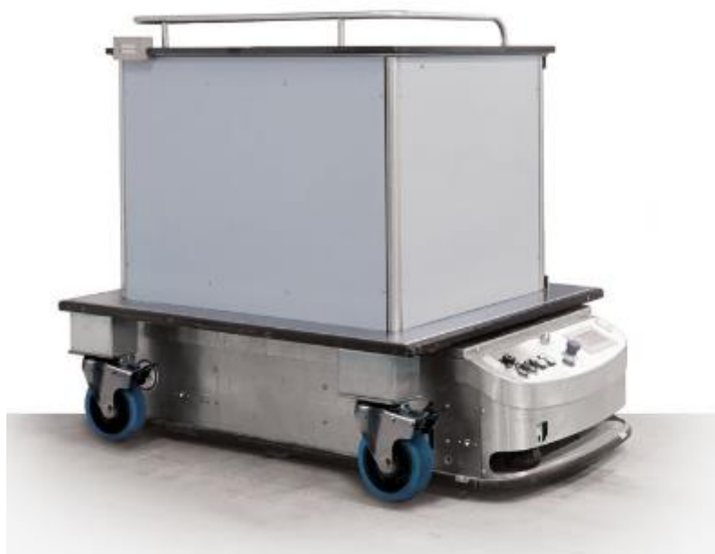
Рисунок 19 - Автоматическая транспортная тележка системы Robotug с автоматической стабилизацией курса.
