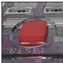
Рисунок 38 – Кнопка сброса параметров на контроллере PRIZM
