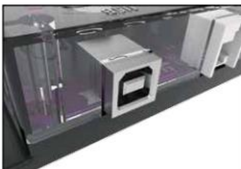
Рисунок 37 – Порт USB на контроллере PRIZM, предназначенный для программирования и связи
