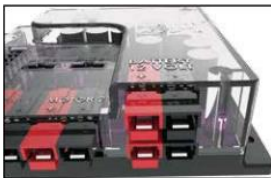
Рисунок 41 – Порт ввода/вывода напряжения аккумуляторной батареи контроллера PRIZM
