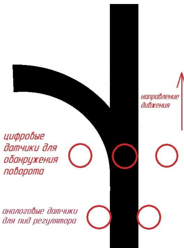
Рисунок 54 – Расположение инфракрасных датчиков линии
