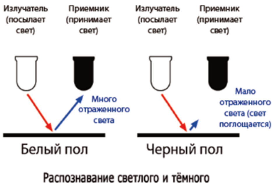
Рисунок 44 - Принцип действия инфракрасного датчика линии.
