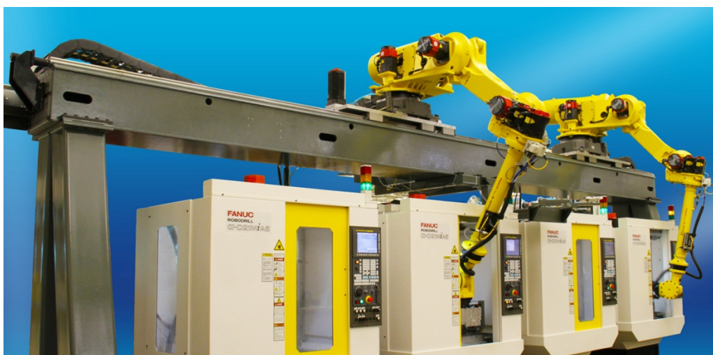
Рисунок 12 – Портальный робот-манипулятор, жёстко закреплённый на направляющей
