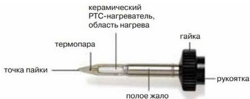
Рисунок 10 – Устройство керамического паяльника
