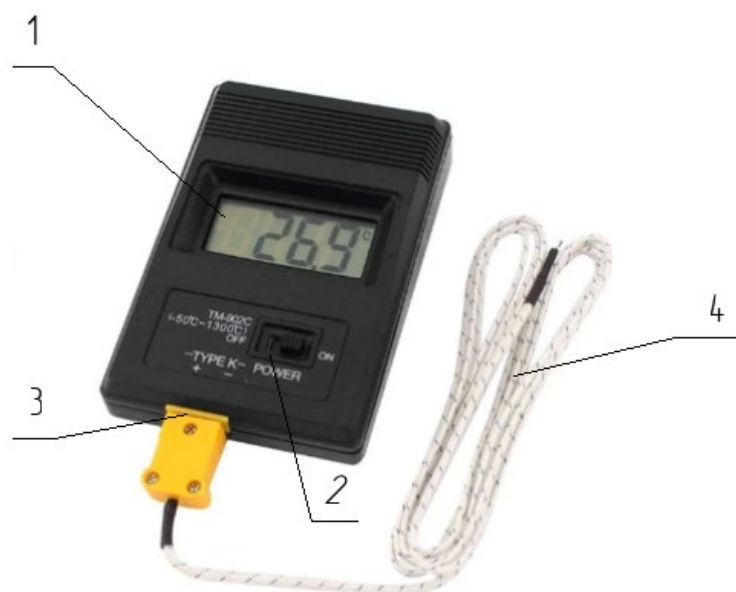
Рисунок 29 – Термометр TM902C: 1 – ЖК-дисплей; 2 – переключатель включения/выключения; 3 – гнездо для подключения термопары; 4 – температурный щуп ТТД-01
