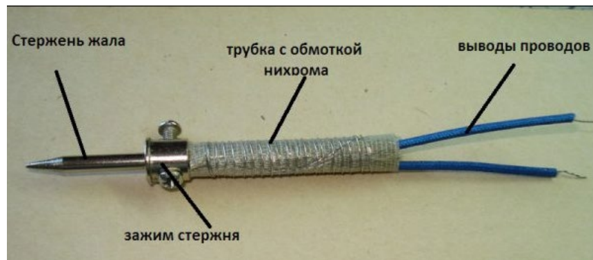
Рисунок 8 – Устройство паяльника с нихромовой спиралью
