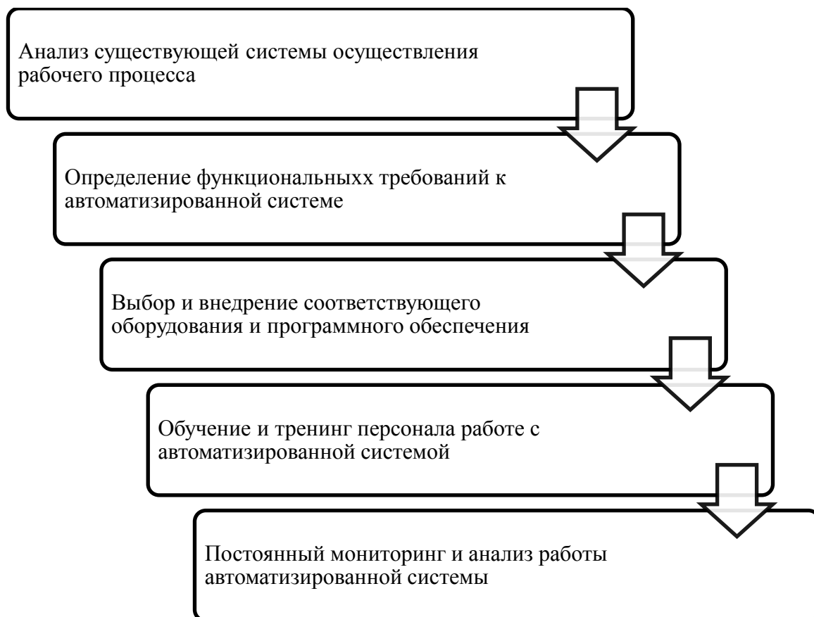
Рисунок 3 – Этапы программы внедрения автоматизированного рабочего места супервайзера на буровой скважине
