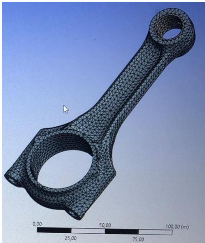
Рисунок 44 – Общий вид конечно-элементной модели шатуна
