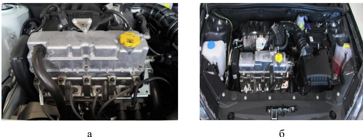
Рисунок 1 – Общий вид двигателя: а – ВАЗ-11182; б – ВАЗ-11189
