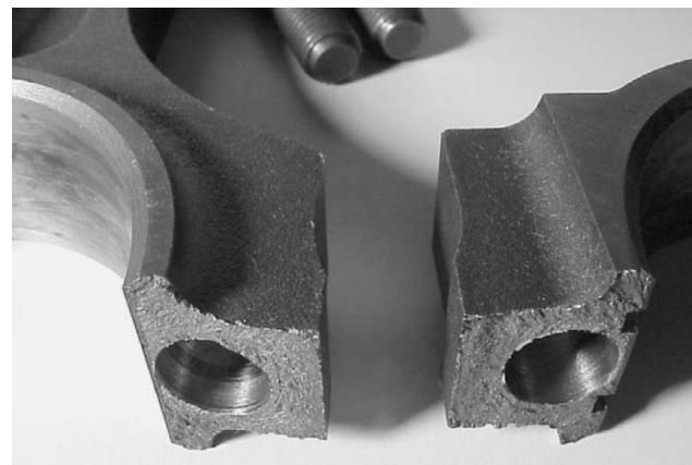
Рисунок 8 – Разъем нижней головки шатуна и крышки
