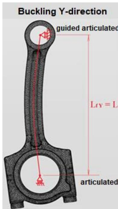
Рисунок 38 – Изгиб шатуна в Y-направлении
