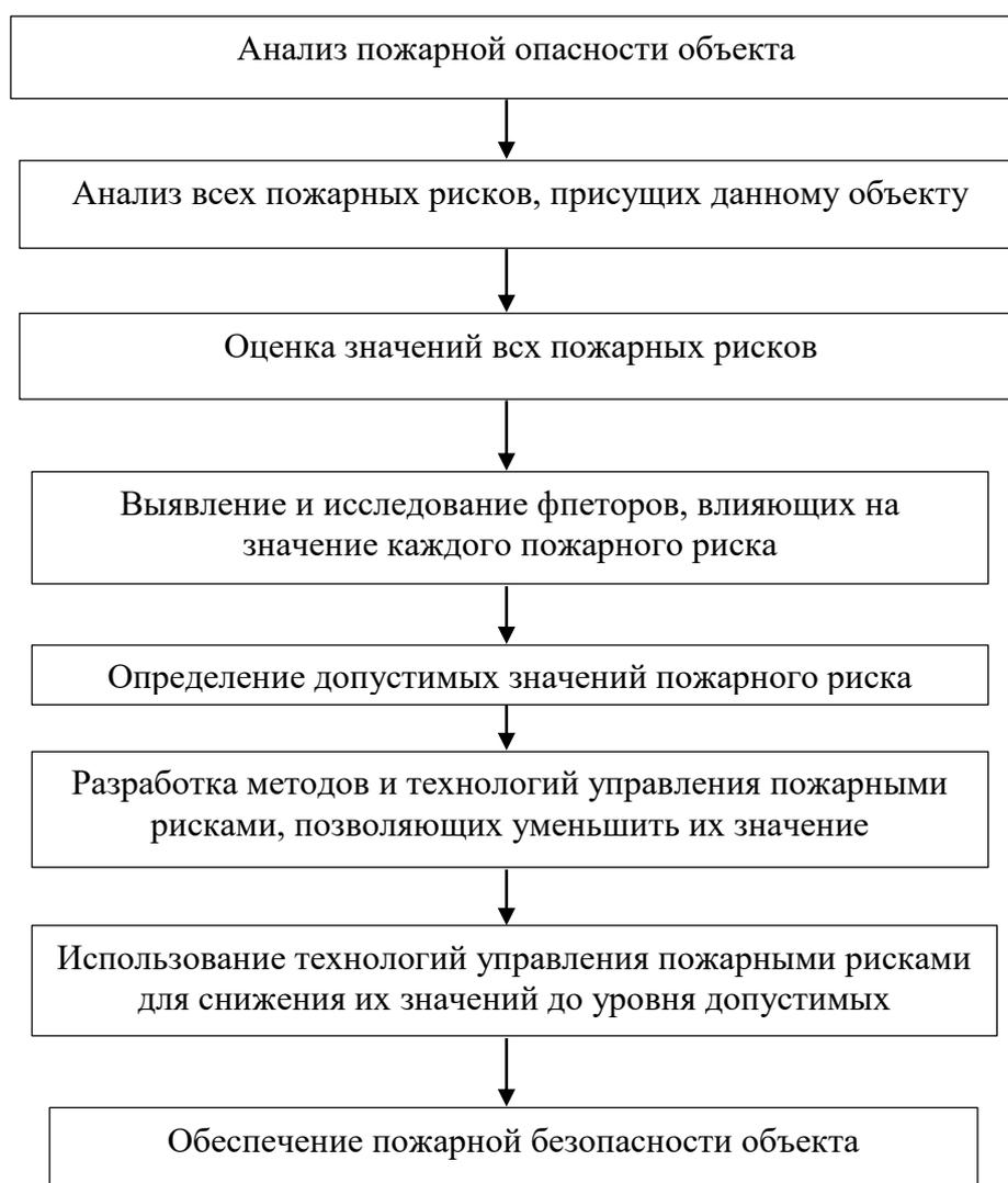
Рисунок 4 – Общий алгоритм оценки пожарной безопасности
