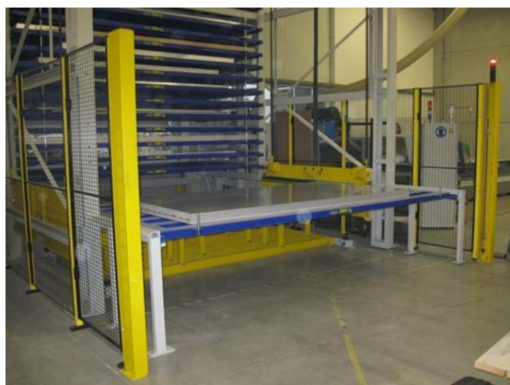
Рисунок П.2 – Вертикальная лифтовая система хранения АСС СТТ 1.0
