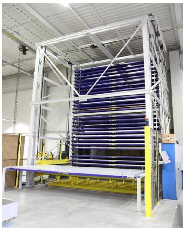
Рисунок П.1 – Вертикальная лифтовая система хранения АСС СТТ 1.0
