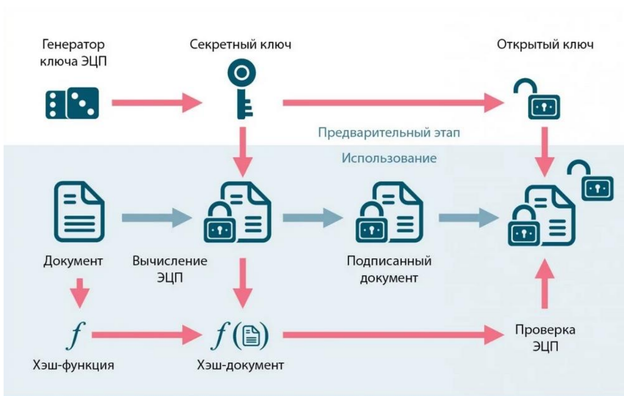
Рисунок 3 – Нанесение и проверка ЭЦП
