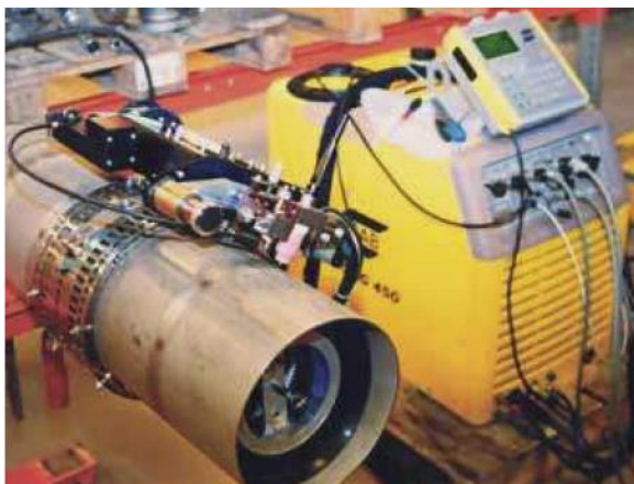
Рисунок 7 – Автоматическая сварка при помощи источника Protig 450
