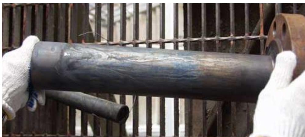
Рисунок 5 – Внешний вид отложений на элементе реакционной трубы
