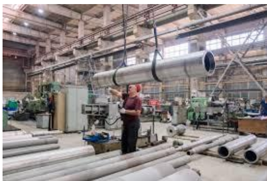
Рисунок 1 – Изготовление реакционных труб
