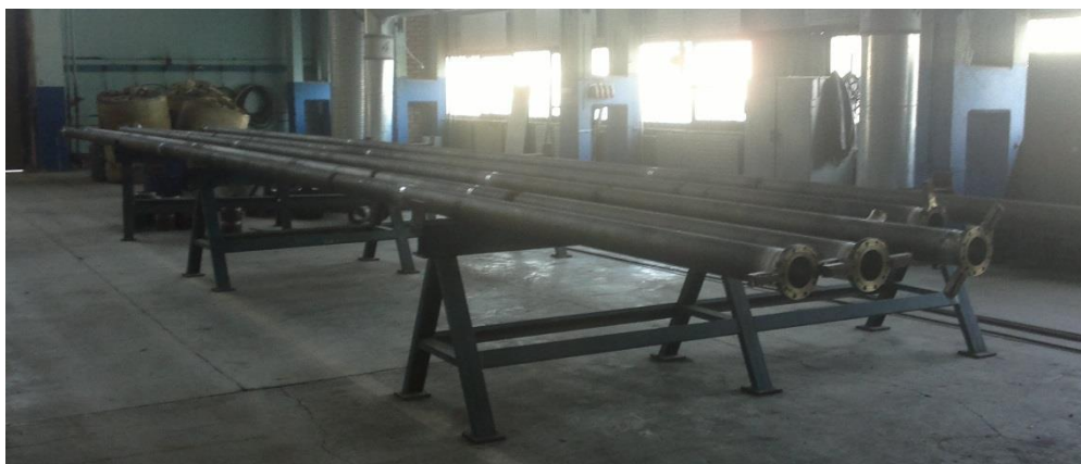
Рисунок 3 – Реакционные трубы в цехе после сборки и сварки
