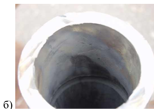
Рисунок 6 – Примеры разрушения реакционных труб: зона «срыва» (а) и трещина в теле трубы (б)
