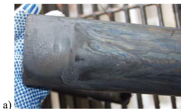
Рисунок 6 – Примеры разрушения реакционных труб: зона «срыва» (а) и трещина в теле трубы (б)
