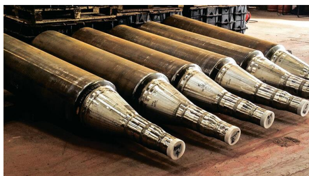
Рисунок 1 – Изготовление реакционных труб
