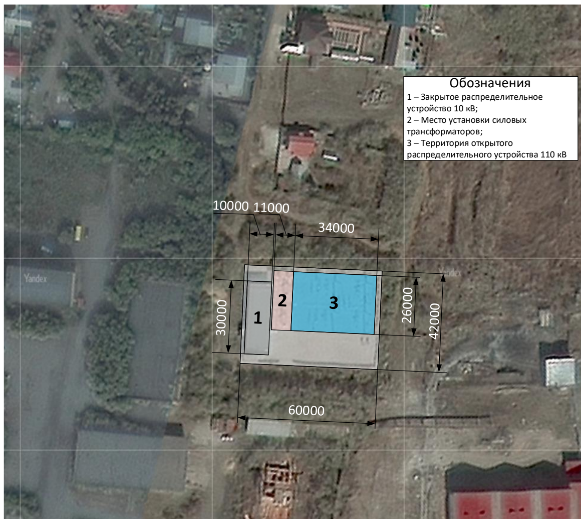
Рисунок 12 - Компоновка подстанции «Карбышево»
