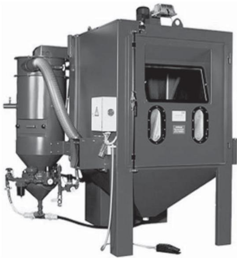
Рисунок 11 - Общий вид установки для дробеструйной обработки
