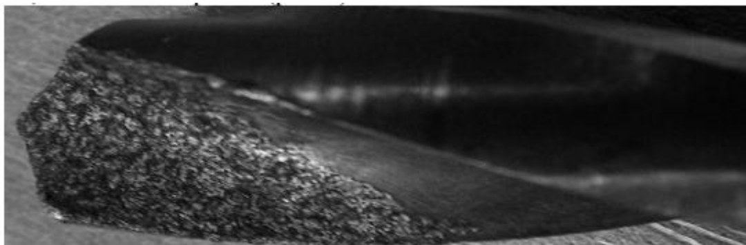
Рисунок 46 – Режущая часть сверла с покрытием, нанесенным методом ЭИЛ
