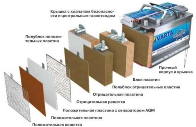
Рисунок 2 - Свинцово-кислотный аккумулятор технологии AGM
