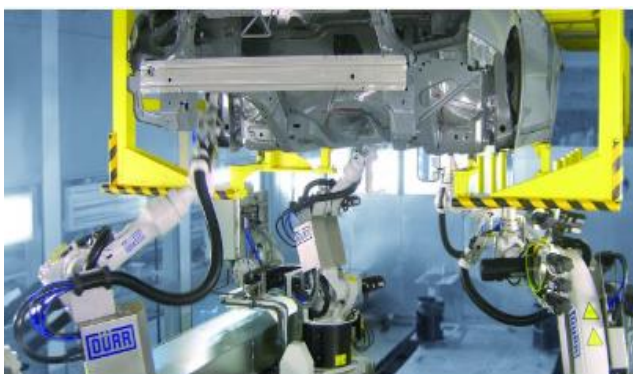
Рисунок 14 – Вертикальный автоматизированный способ нанесения мастики
