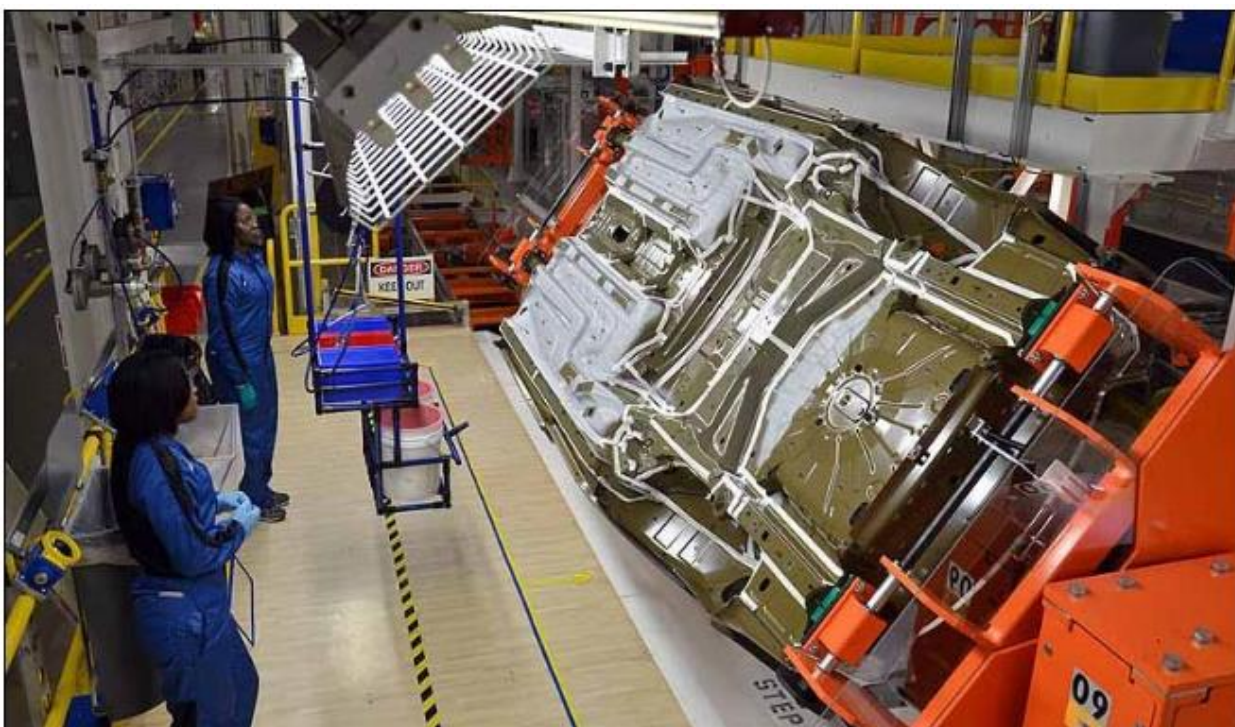
Рисунок 13 – Подача кузовов по конвейеру при ручном нанесении мастики
