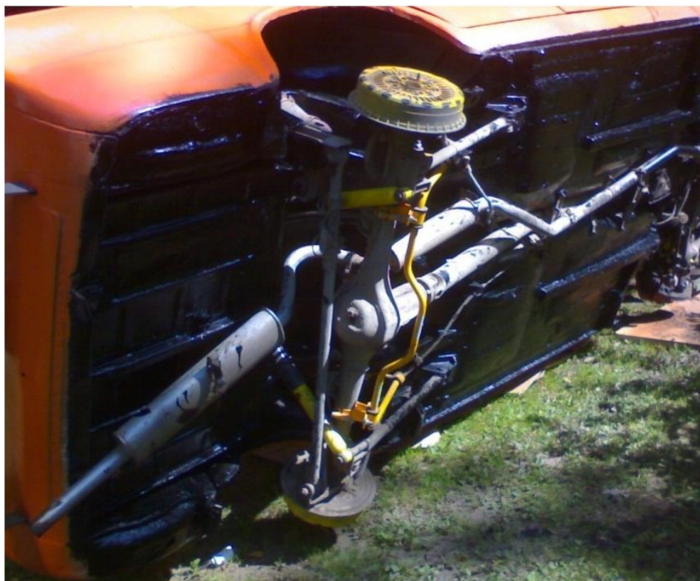
Рисунок 11 – Днище автомобиля с резинобитумным покрытием
