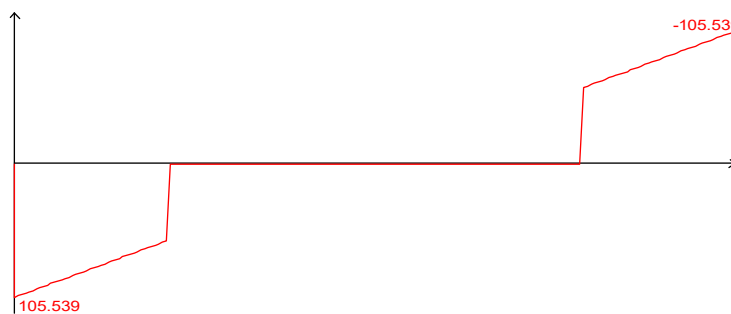
Рисунок 21 – Основное сочетание. Минимальный изгибающий момент (кН*м)» [24]
