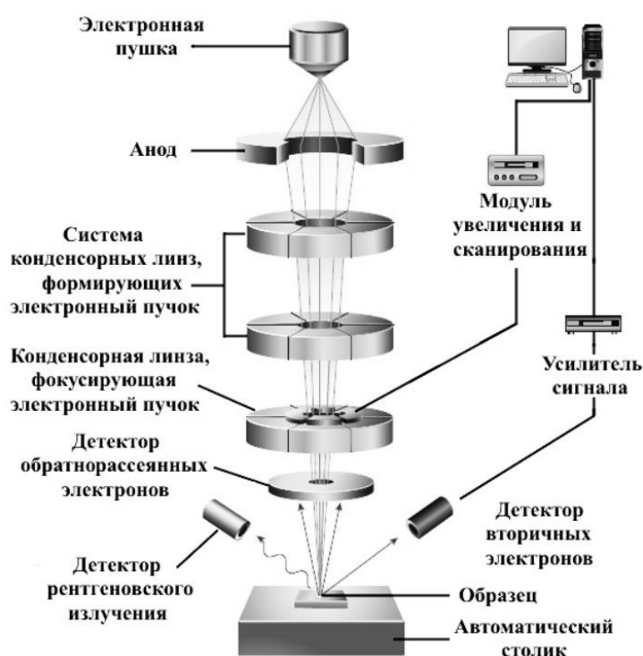
Рисунок 12 – Принципиальная схема сканирующего (растрового) электронного микроскопа [25]
