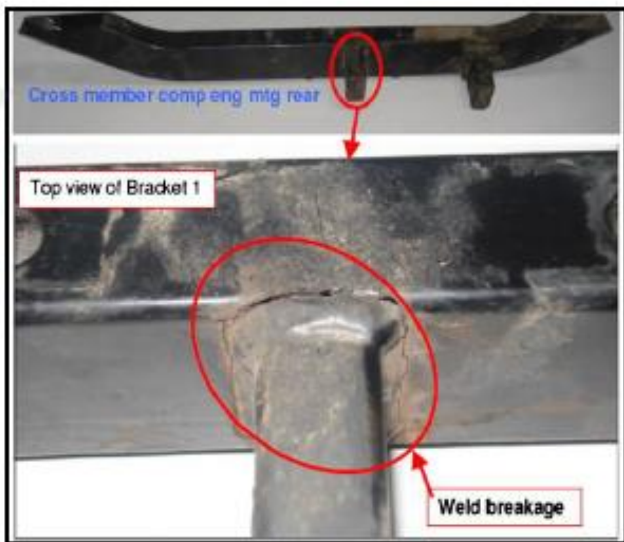
Рисунок 2 – Вышедший из строя кронштейн на 14 402 км [3]
