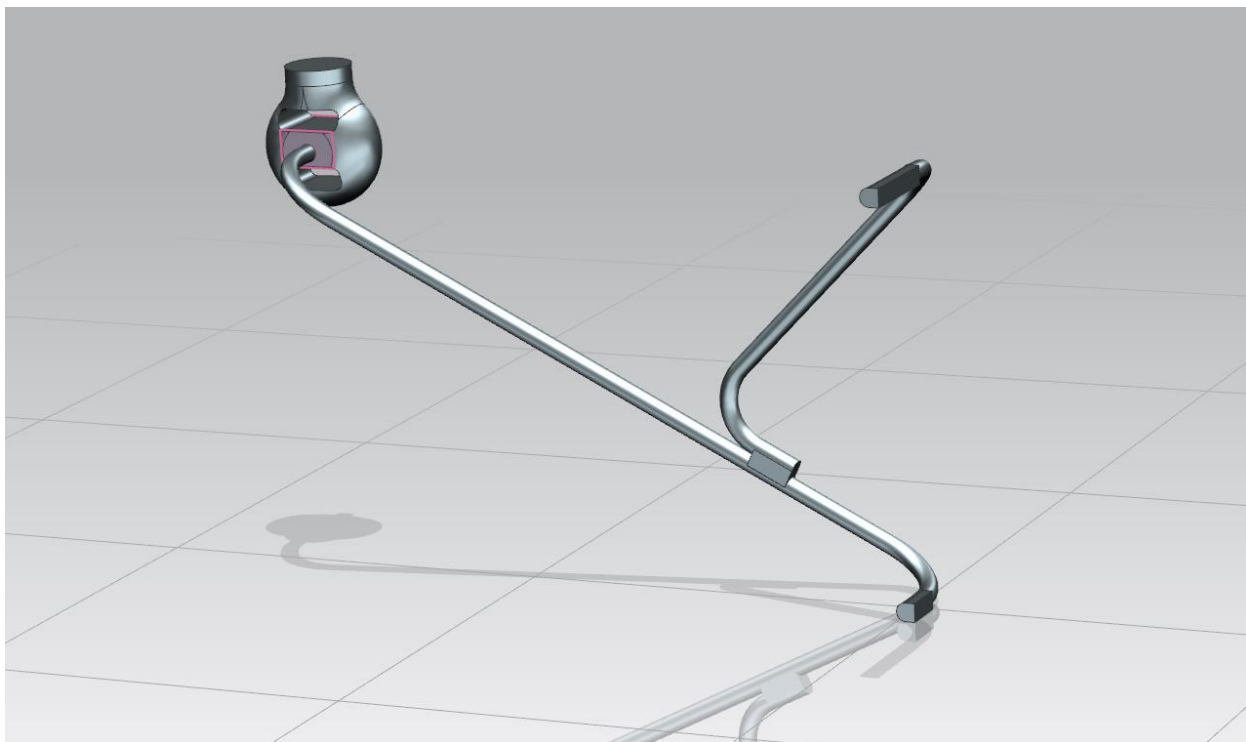
Рисунок 23 – Кронштейн вместе с резиновым буфером
