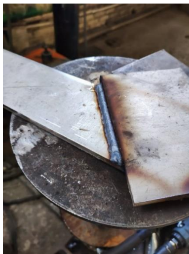
Рисунок 24. Нахлесточное сварное соединение.
