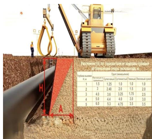
Рисунок 19 – Разметка участка траншеи для установки кран-трубоукладчика
