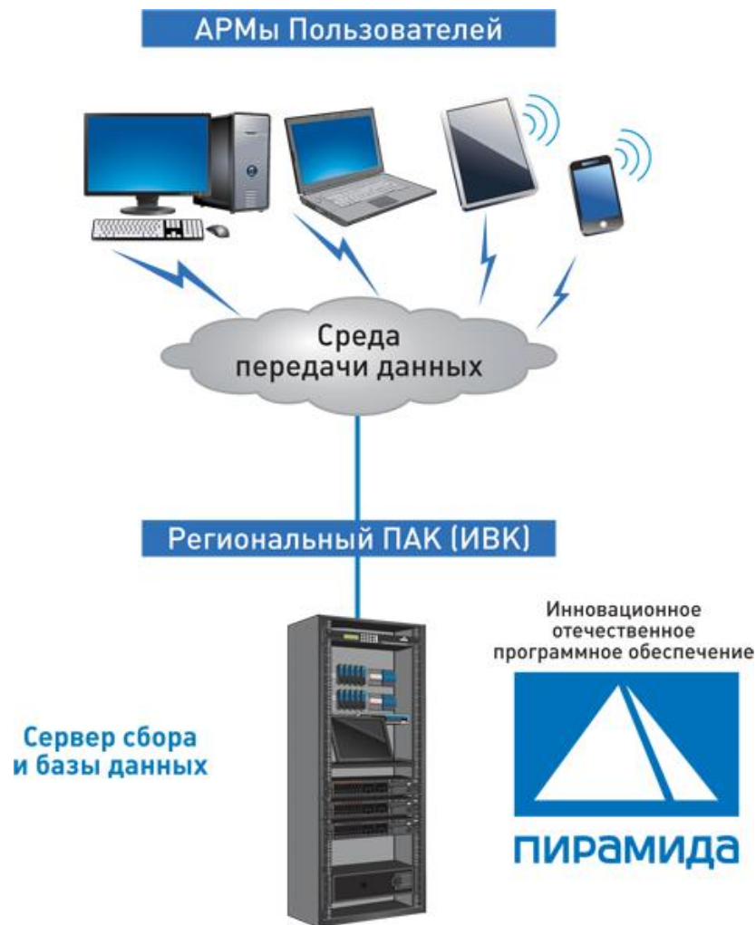
Рисунок 8 – Структура АИИСКУЭ «Пирамида-2», выбранная для установки в системе электроснабжения предприятия ООО «Фитнес Фуд» (г. Тольятти)
