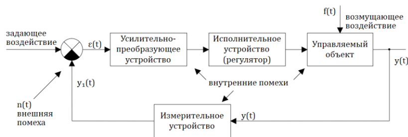
Рисунок 1 – Структурная схема регулятора
