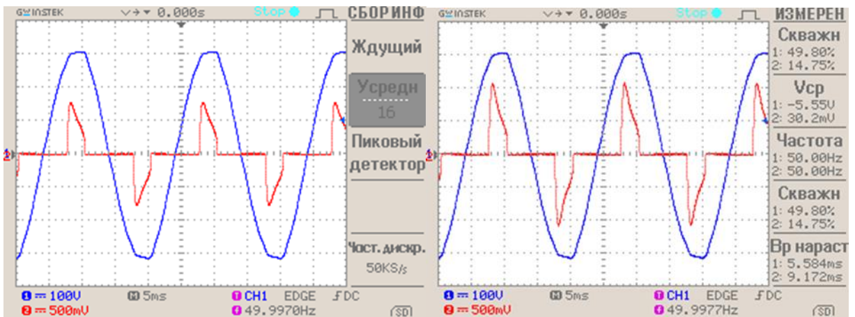
Рисунок 26 - Осциллограммы входного напряжения и входного тока при нагрузке 75%
