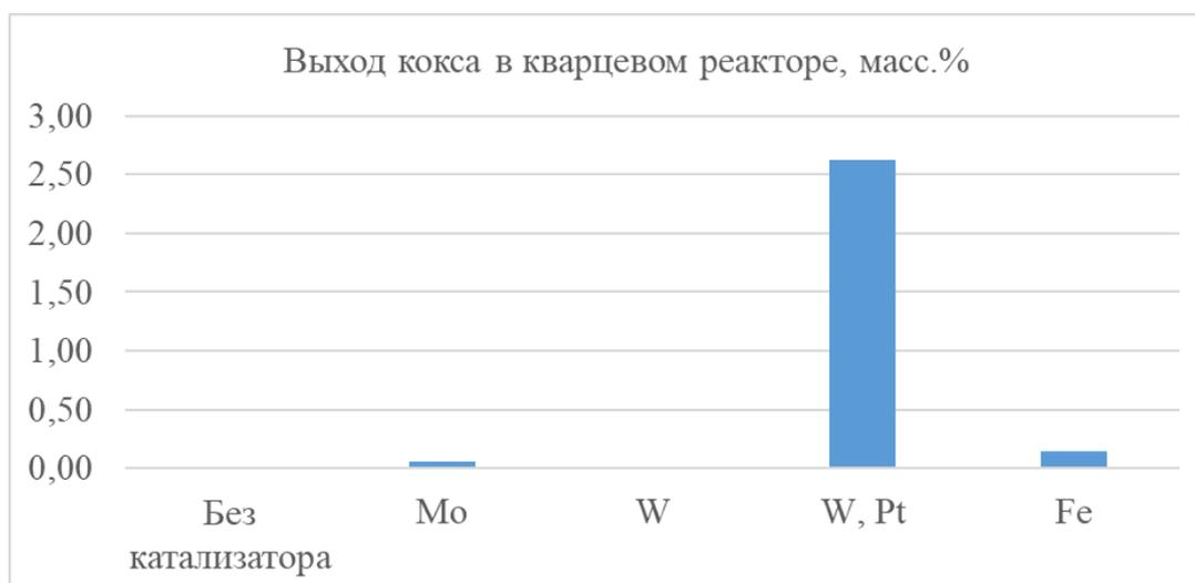
Рисунок 5 – Выход кокса в кварцевом реакторе
