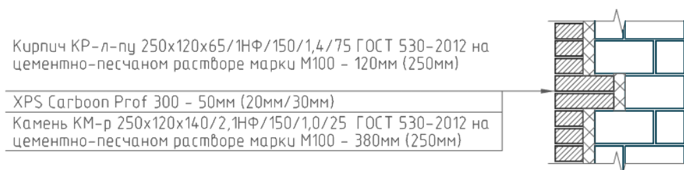
Рисунок 1 - Конструкция наружной стены
