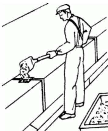
Рисунок 15 - Заделка швов между фундаментными блоками
