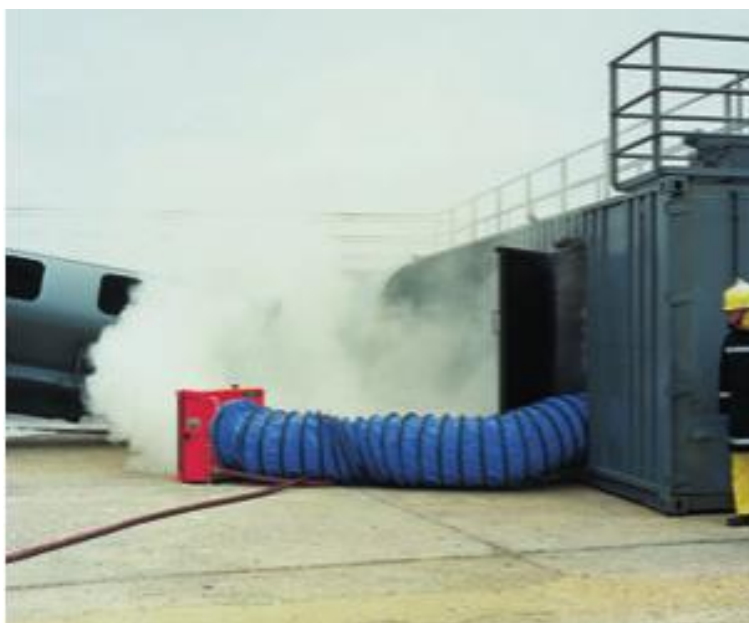
Рисунок 15 – Использование установки «FOMAX 7» в качестве дымососа
