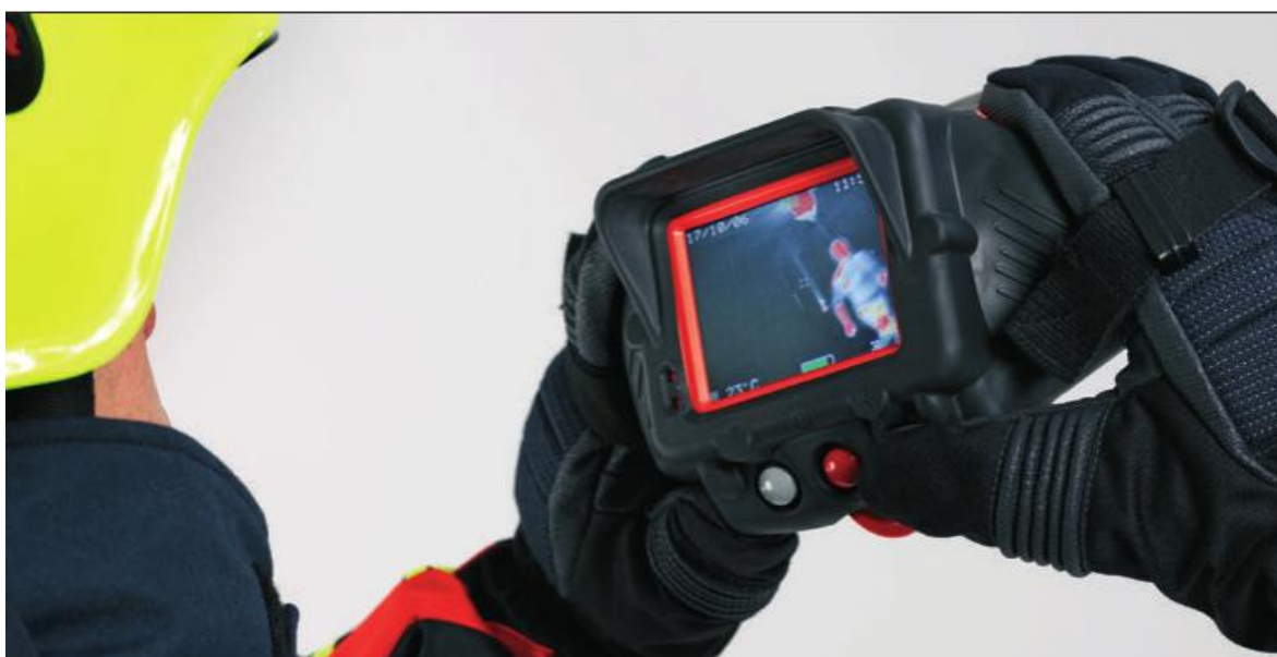
Рисунок 19 – Использование тепловизионной камеры «АРГУС 4»
