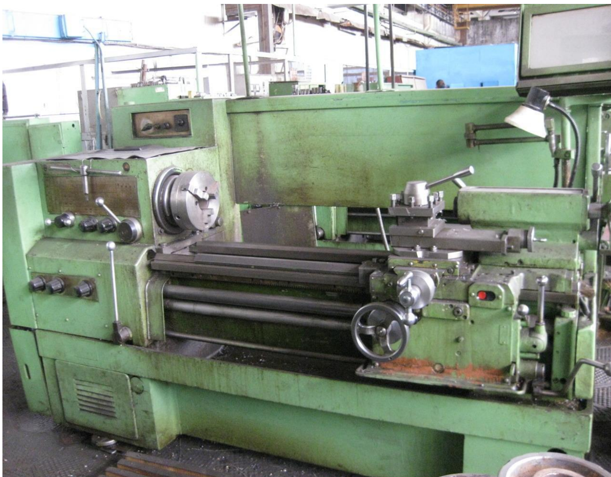
Рисунок 12 - Винторезный станок марки 16К20, на котором работает токарь
