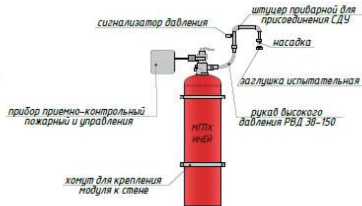
Рисунок 12 - Схема модульной установки газового тушения пожара
