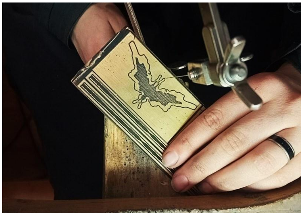
Рисунок В.6 – Федосова К.В. Процесс выпилки деталей кольца «Карточка №5», 2023 г.
