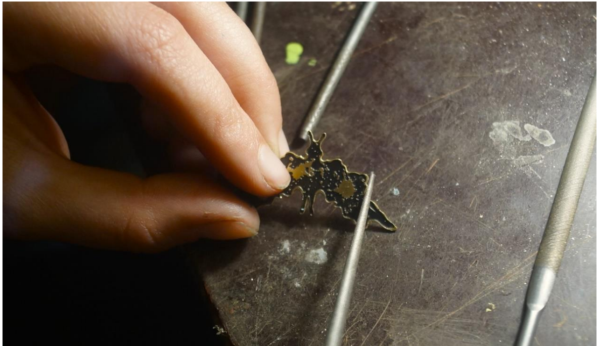
Рисунок В.7 – Федосова К.В. Процесс выпилки деталей кольца «Карточка №5», 2023 г.
