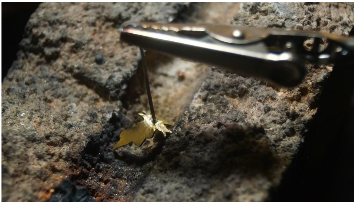
Рисунок В.8 – Федосова К.В. Процесс пайки деталей кольца «Карточка №5», 2023 г.
