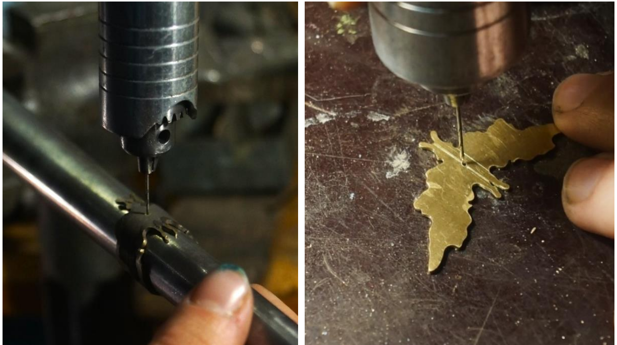
Рисунок В.9 – Федосова К.В. Процесс сверловки деталей кольца «Карточка №5», 2023 г.
