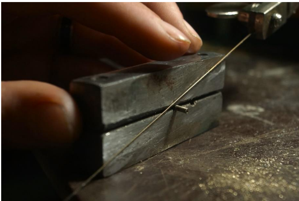
Рисунок В.10 – Федосова К.В. Процесс выпилки деталей кольца «Карточка №5», 2023 г.
